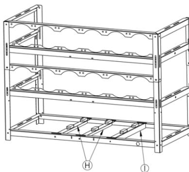
5° - Próximo passo fixar peça J, travessa de fixação das GPU's para as duas fileiras, conforme imagem abaixo .
